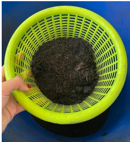
ภาพที่ 46 นำดินที่ตากแล้วมาร่อน
