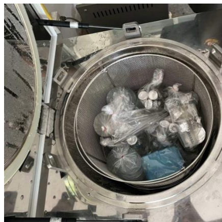
ภาพผนวกที่ 1 : การนึ่งฆ่าเชื้อ (Sterilization) อุปกรณ์ในการทดลอง โดยใช้หม้อนึ่งความดันไอน้ำอัตโนมัติ (Autoclave)
