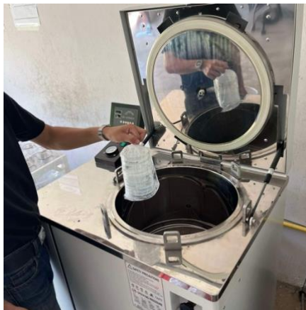
ภาพผนวกที่ 1 : การนึ่งฆ่าเชื้อ (Sterilization) อุปกรณ์ในการทดลอง โดยใช้หม้อนึ่งความดันไอน้ำอัตโนมัติ (Autoclave)
